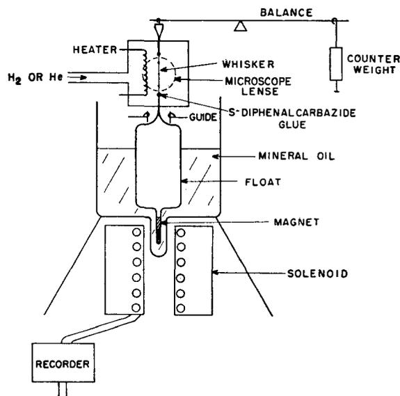
FIG. 1. Micro tensile machine.
